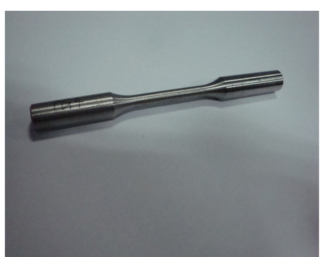
Specimen type 1: Solid specimens (GB/T 228.1-2010)
